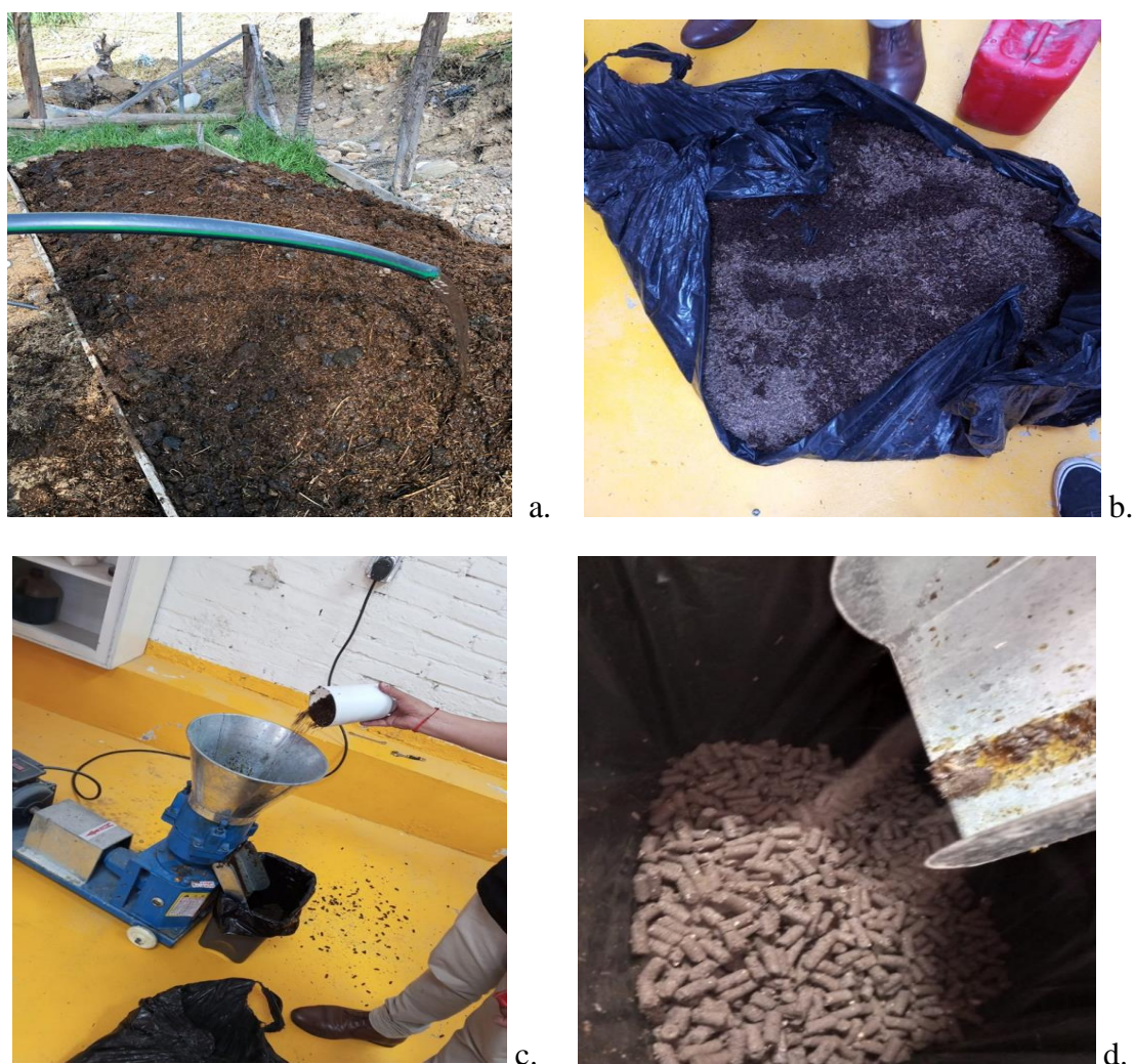
Figura 10. a. Humus de lombriz, b. Abono tamizado y colocado para su respectivo secado, c. Maquina peletizadora, d. Peletizado de humus de lombriz (producto final).
